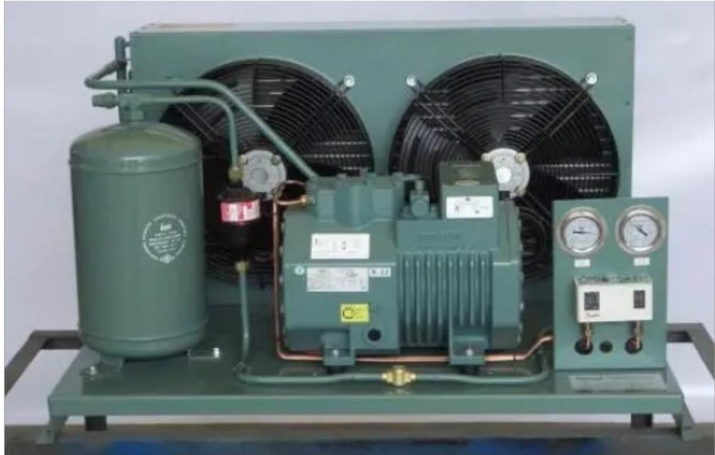
一般制冷机的制冷原理压缩机的作用是把压力较低的蒸汽压缩成压力较高的蒸汽，使蒸汽的体积减小，压力升高。压缩机吸入从蒸发器出来的较低压力的工质蒸汽，使之压力升高后送入冷凝器，在冷凝器中冷凝成压力较高的液体，经节流阀节流后，成为压力较低的液体后，送入蒸发器，在蒸发器中吸热蒸发而成为压力较低的蒸汽，再送入压缩机的入口，从而完成制冷循环。利用外界能量使热量从温度较低的物质（或环境）转移到温度较高的物质（或环境）的系统叫制冷系统。制冷系统可分为蒸气制冷系统、空气制冷系统和热电制冷系统。其中蒸气制冷系统又可分为蒸气压缩式、蒸气吸收式和蒸气喷射式。主要部件组成制冷系统由制冷剂和四大机件，即压缩机，冷凝器，膨胀阀，蒸发器组成。压缩机压缩机是制冷循环的动力，它由电动机拖动而不停地旋转，它除了及时抽出蒸发器内蒸气，维持低温低压外，还通过压缩作用提高制冷剂蒸气的压力和温度，创造将制冷剂蒸气的热量向外界环境介质转移的条件。即将低温低压制冷剂蒸气压缩至高温高压状态，以便能用常温的空气或水作冷却介质来冷凝制冷剂蒸气。
